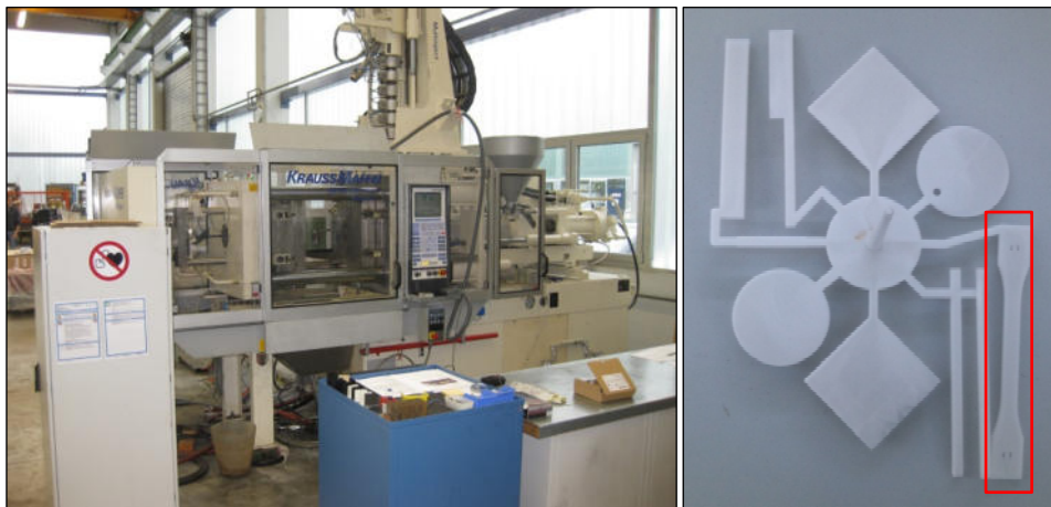
Bild 3.8 Spritzgießmaschine zur Herstellung der Zugstab-Probekörper links: Standard-Spritzgießmaschine vom Typ 125-390-60 CZ rechts: Gespritzter Zugstab-Probekörper mit Stangenanguss und runder Verteilerscheibe
