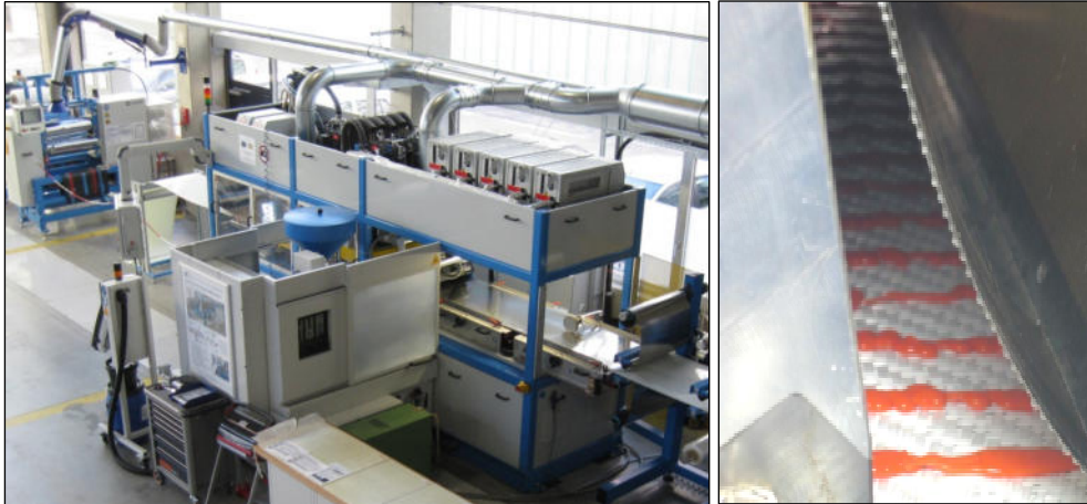
Bild 3.9 Intervall-Heißpresse zur Herstellung der konsolidierten Halbzeugproben links: Intervall-Heißpresse vom Typ HP007 rechts: Heißkanalverteiler-Werkzeug mit sechszehn extrudierten Schmelzesträngen
