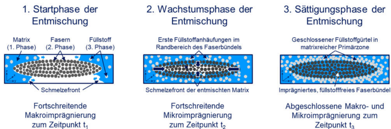
Bild 6.1 Prozessmodell des textilen Entmischungsvorgangs (textiler Filtereffekt)
